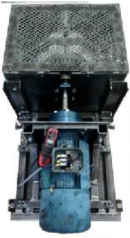
11kW Motor on test
